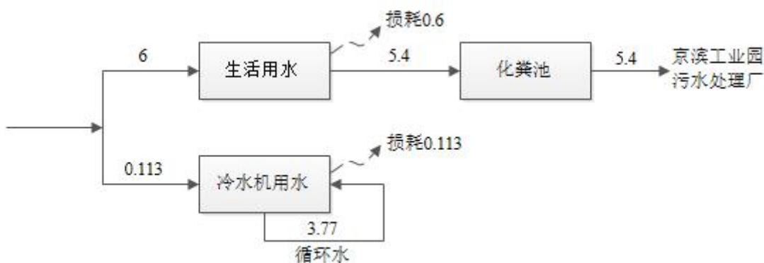
图 2-2 本项目扩建后全厂水平衡图 单位: \text{m}^3/\text{d}
