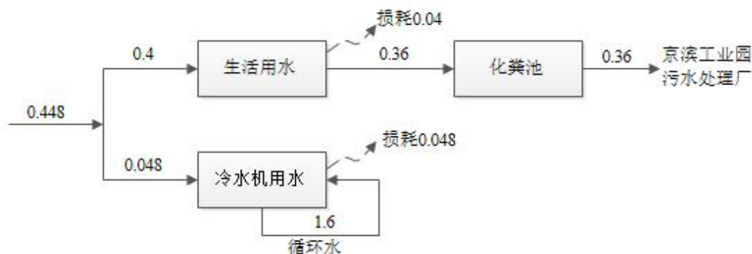
图 2-1 本项目水平衡图 单位：m 3 /d
